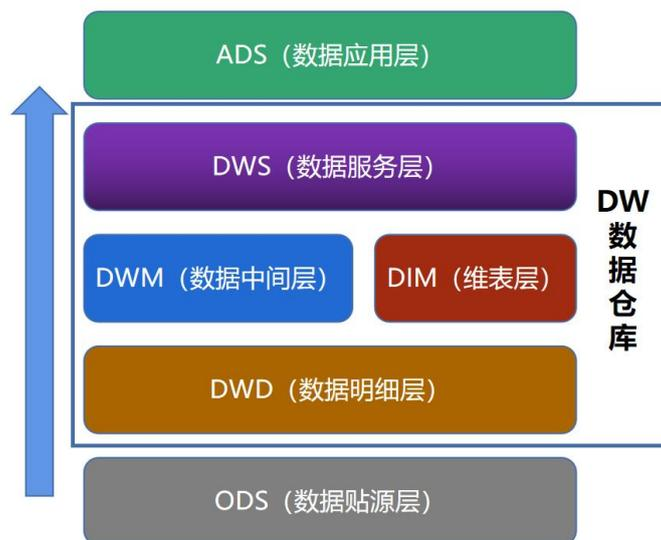
图1 数据模型架构中数据存储的层次
